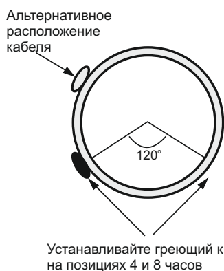
Рис.4 Установка кабеля вдоль трубы
